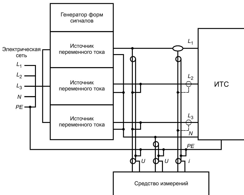
$L_1, L_2, L_3$  — фазные проводники;  $N$  — нейтральный проводник;  $PE$  — проводник защитного заземления;
