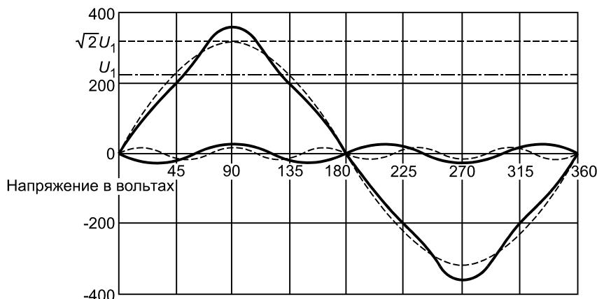
Рисунок 6 — Форма испытательного сигнала при испытаниях «треугольные импульсы»
