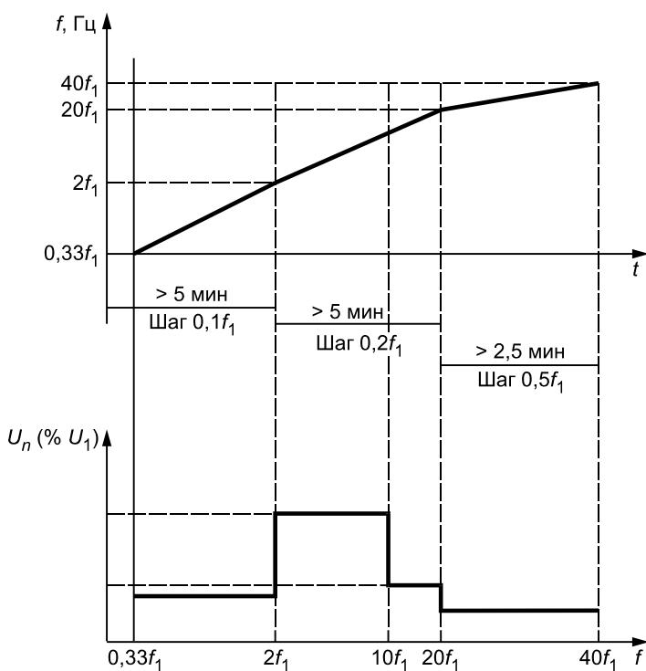
Рисунок 7 — Пример перестройки частоты при испытаниях ТС
