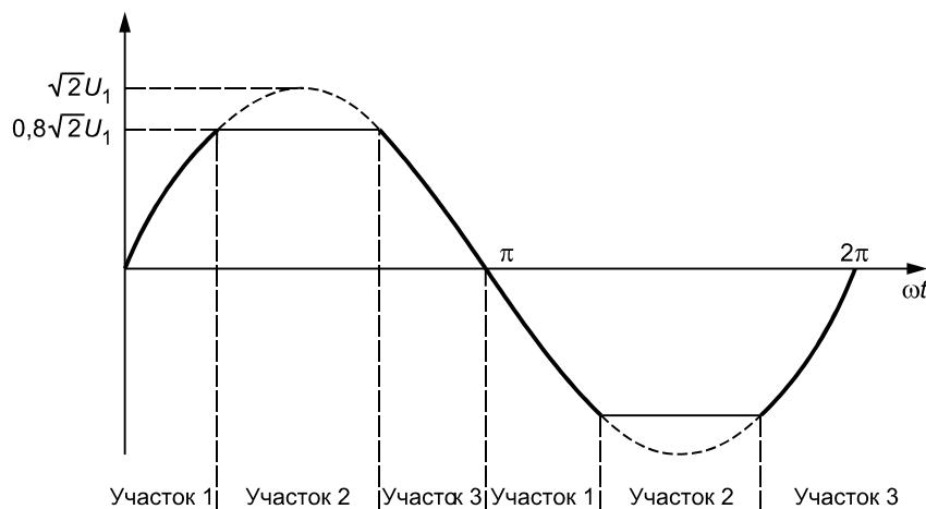
Рисунок 5 — Форма испытательного сигнала при испытаниях «ограниченная синусоида»
