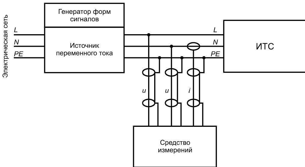
Рисунок 1 — Схема испытательной установки с использованием однофазного ИГ
