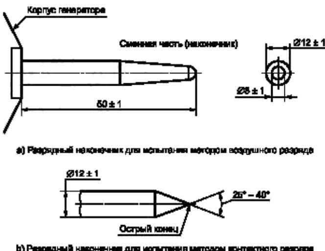
Рисунок 3 – Разрядные наконечники испытательного генератора
