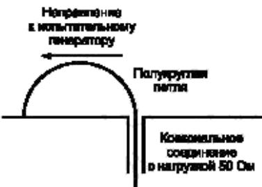
Рисунок D.3 – Полукруглая петля на пластине заземления
