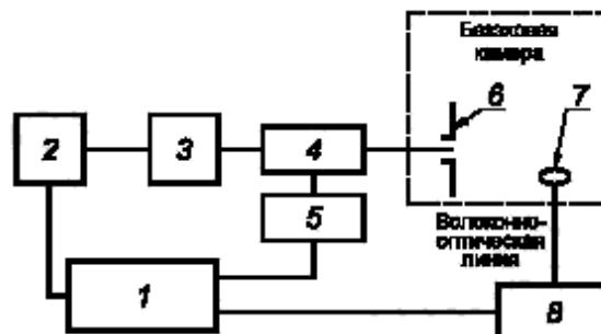
1 — контроллер, например персональный компьютер; 2 — генератор сигналов; 3 — усилитель мощности; 4 — направленный ответвитель; 5 — измерительный прибор; 6 — передающая антenna; 7 — антenna (датчик) для измерения напряженности поля; 8 — измеритель напряженности поля
