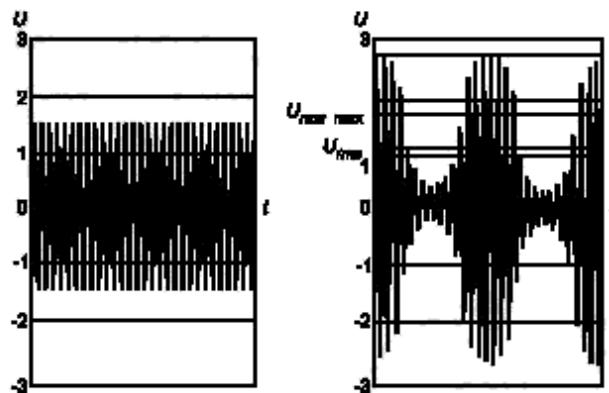
a) Немодулированный радиочастотный сигнал (пиковое значение напряжения  $U_p = 1,4$  В, среднеквадратичное значение напряжения  $U_{rms} = 1$  В);
