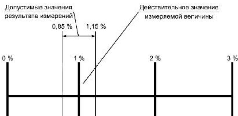
Рисунок 5 - Пример неопределенности измерений несимметрии напряжений
