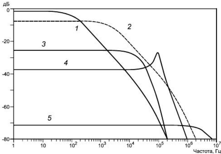
1 - испытательный сигнал 10 мкс (длительность фронта)/1000 мкс (длительность импульса); 2 - **микросекундная импульсная помеха большой энергии (импульс напряжения 1/50 мкс)**; 3 - **микросекундная импульсная помеха большой энергии (импульс тока 6,4/16 мкс)**; 4 - **одиночная колебательная затухающая помеха с частотой колебаний 100 кГц**; 5 - **пачки наносекундных импульсных помех 5/50 нс**
