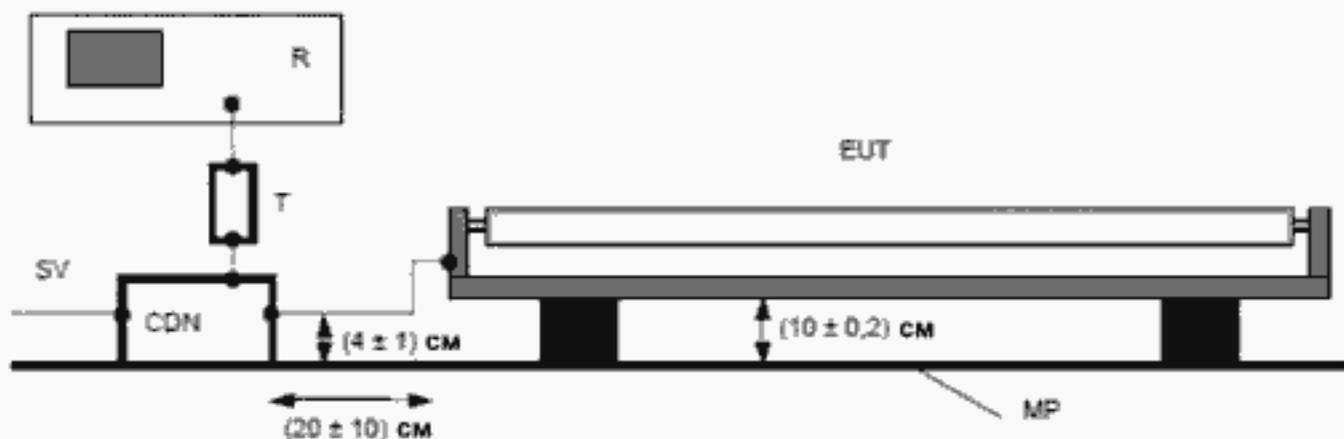
R – измерительный приемник; SV – напряжение питания; MP – заземленная металлическая пластина; CDN – устройство связи/развязки; EUT – испытуемое оборудование; T – аттенуатор 6 дБ, 50 Ом.
