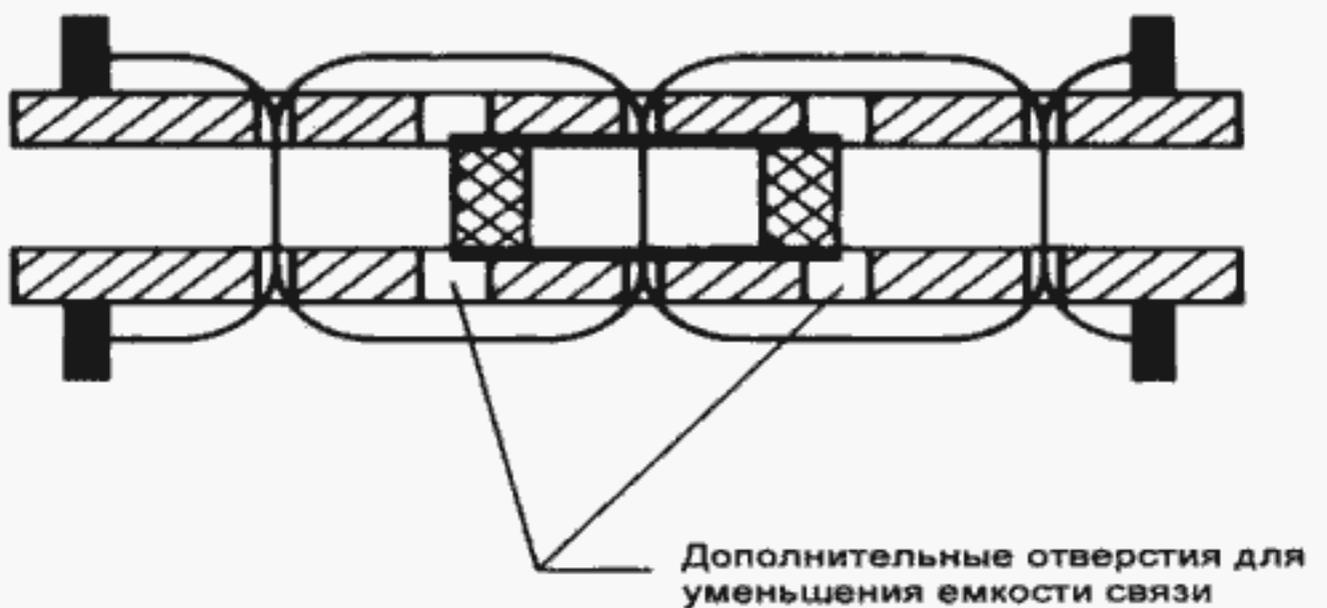
Рисунок А.2b – Детали конструкции сердечника трансформатора
