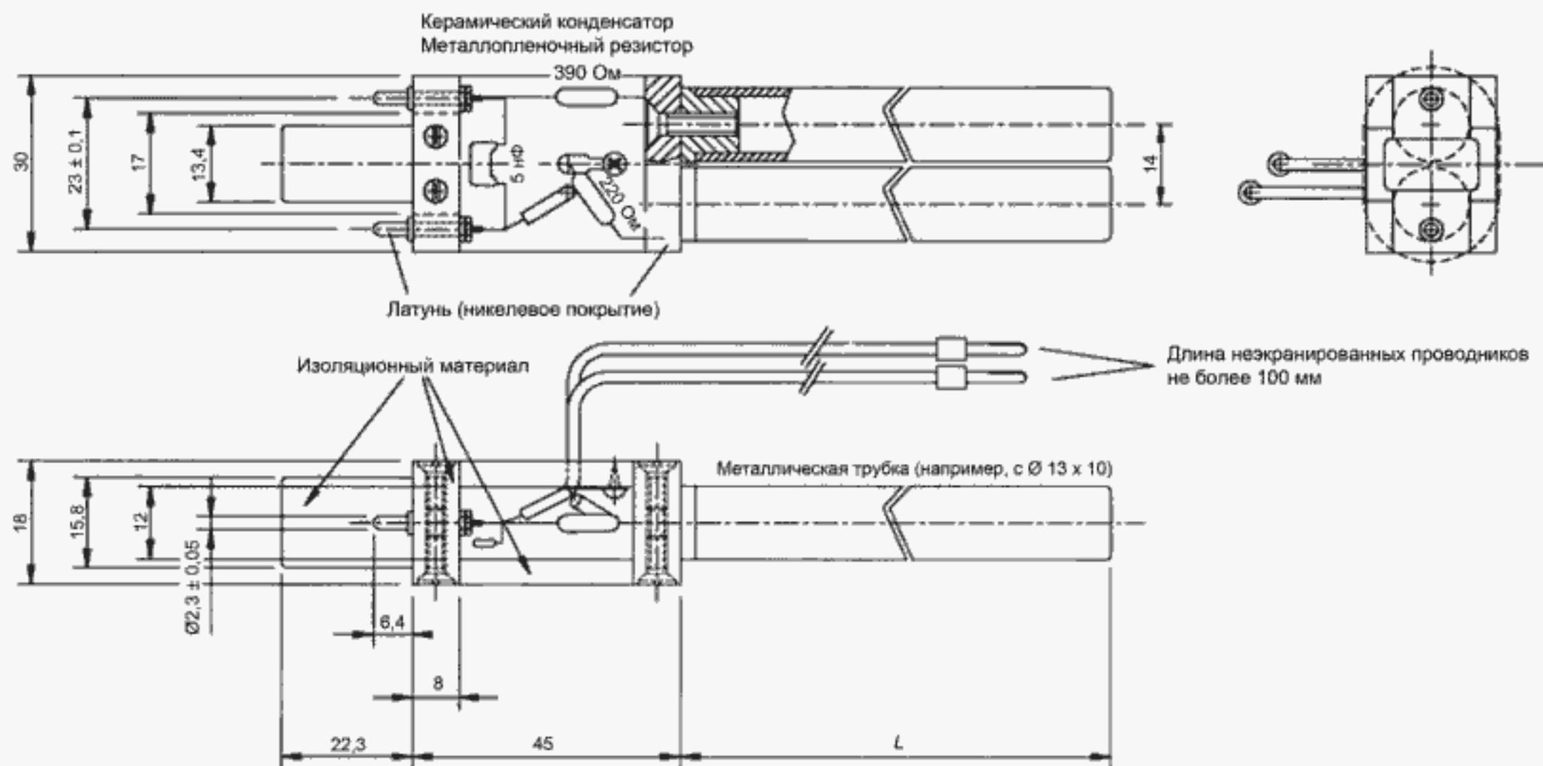
L равно длине реальной люминесцентной лампы минус 45 мм
