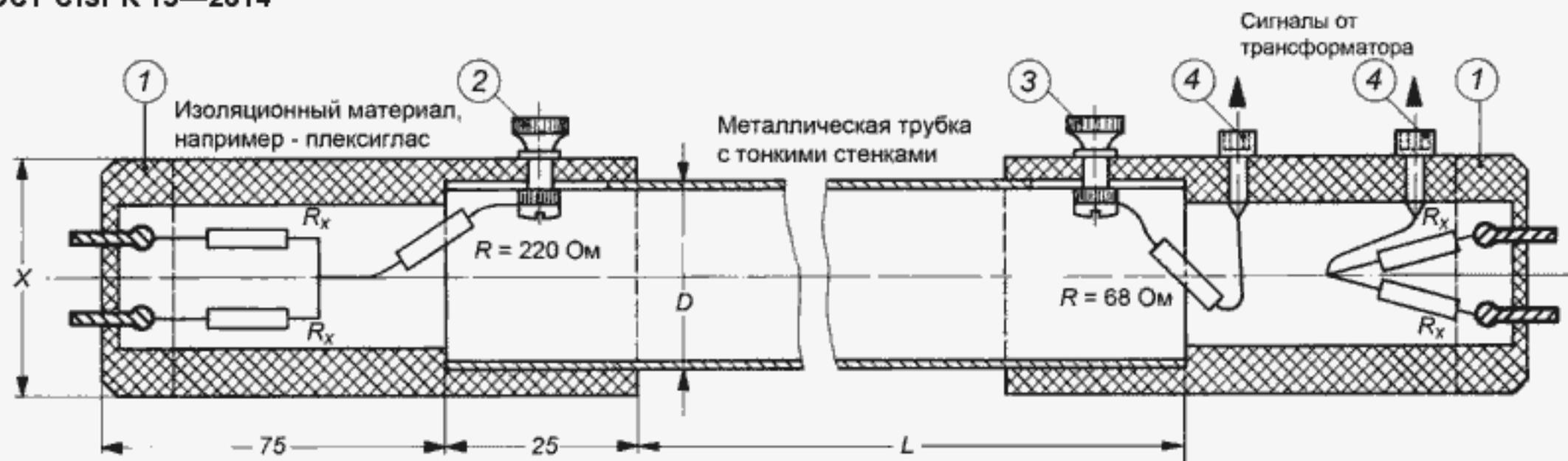
1 – стандартный цоколь с взаимосвязанными штырями; 2 – детализация металлической трубки (изогнута соответствующим образом для U-образных ламп); 3 – винт с гайкой для электрического и механического соединения металлической трубки с цоколем эквивалента лампы; 4 – гнезда, соединенные с симметрирующим трансформатором
