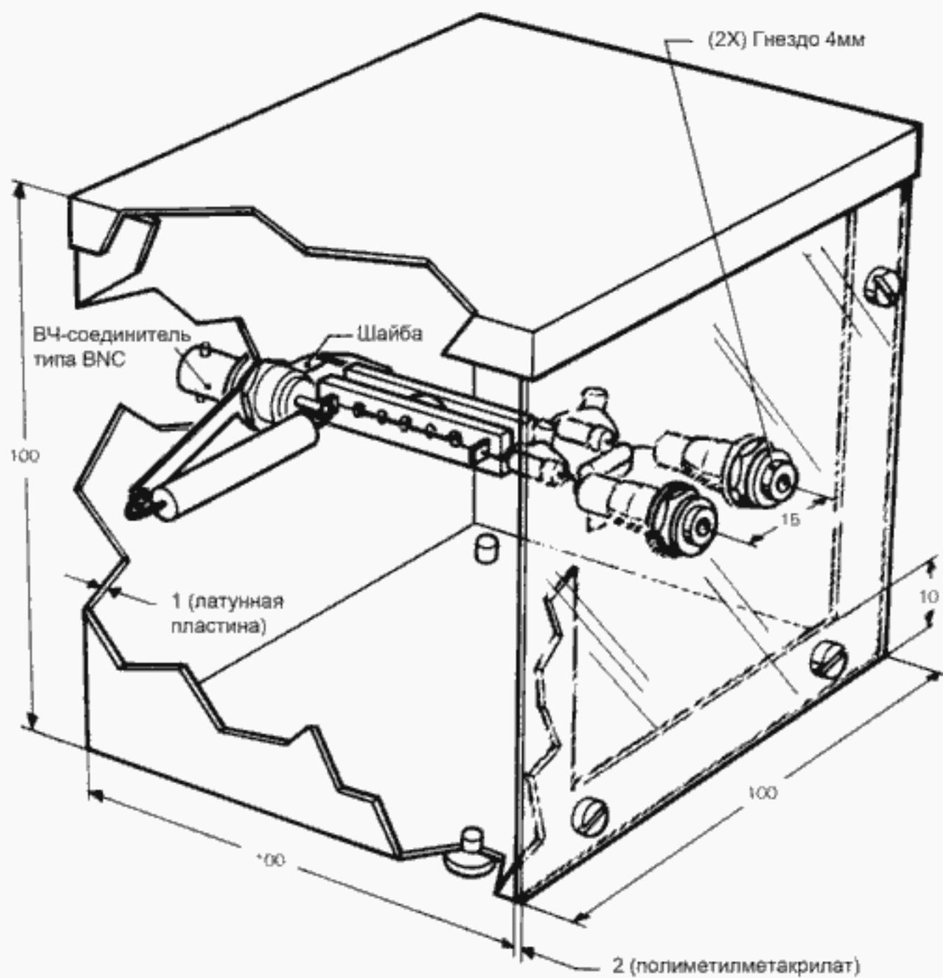
Рисунок А.2d – Конструкция трансформатора
