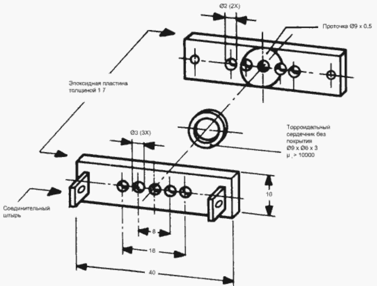
Рисунок А.2b – Детали конструкции сердечника трансформатора
