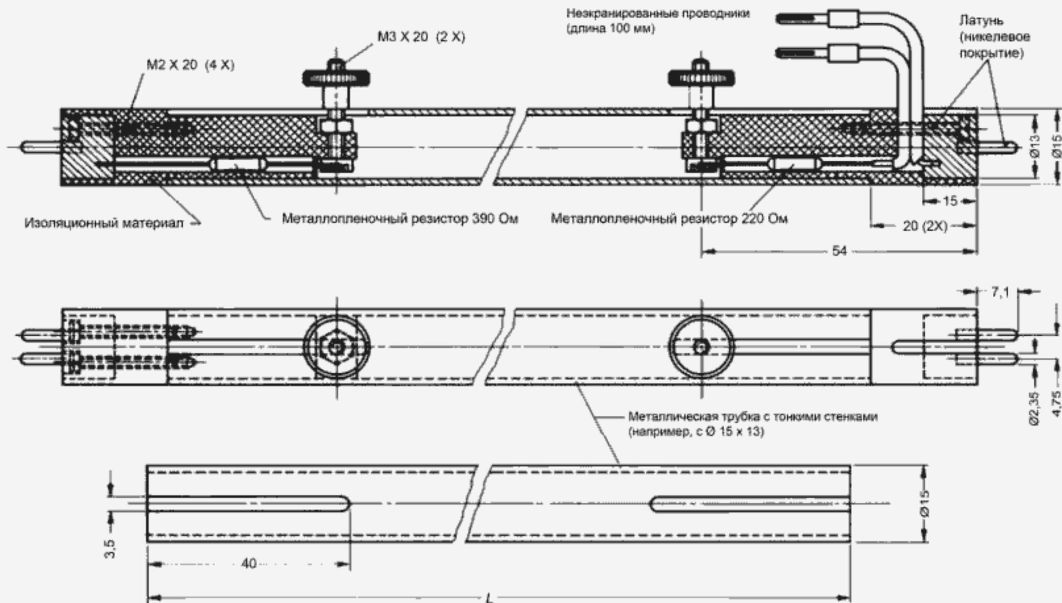
Примечание — Допуски на размеры:  $\pm 1$  по последнему десятичному знаку; допуски на сопротивления:  $\pm 5\%$ , если нет других указаний.  $L$  равна длине реальной люминесцентной лампы минус 40 мм.
