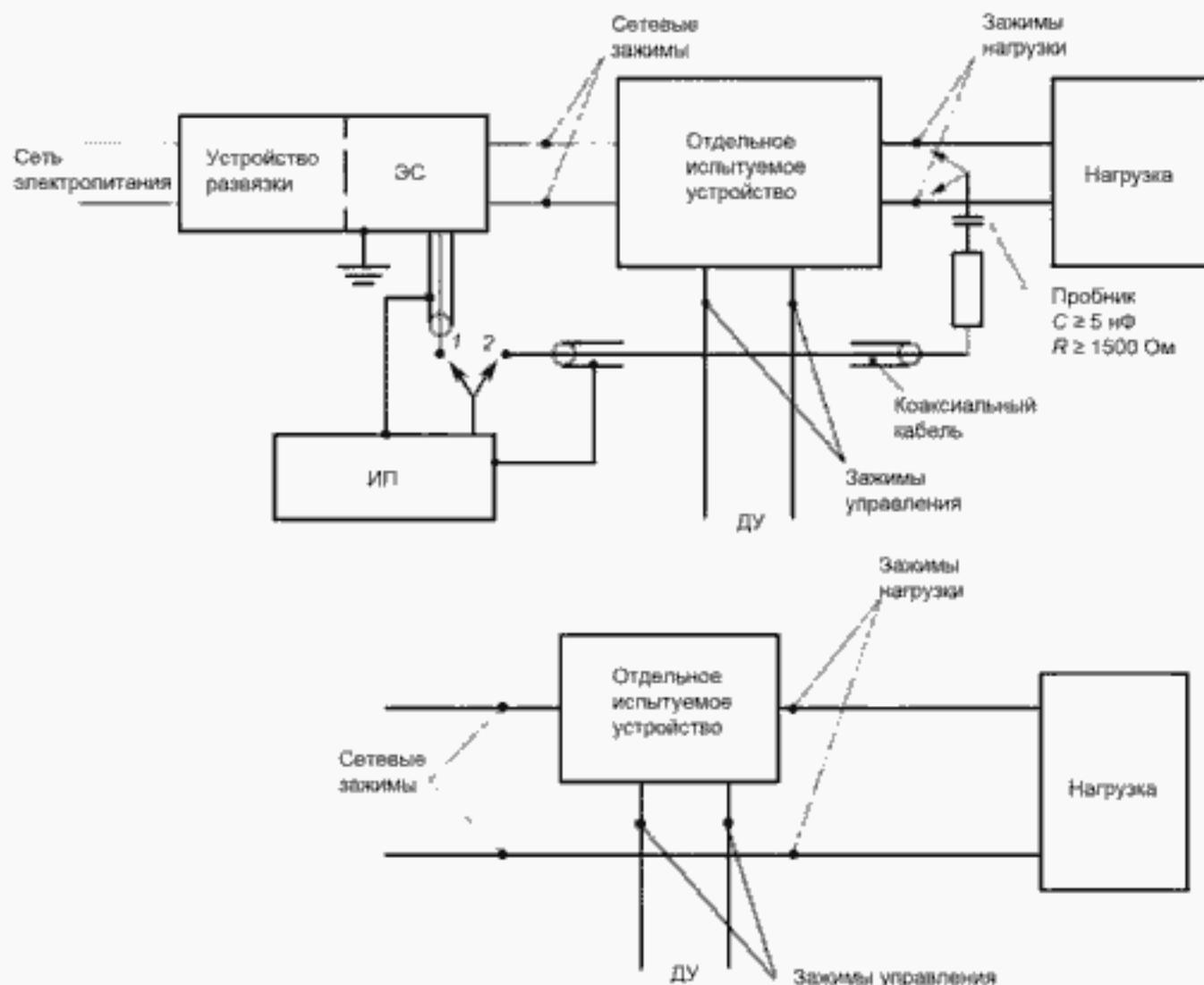
ЭС – V-образный эквивалент сети типа  $50 \text{ Ом}/50 \text{ мкГн} + 5 \text{ Ом}$  (или  $50 \text{ Ом}/50 \text{ мкГн}$ ) по CISPR 16-1-2; ИП – измерительный приемник по CISPR 16-1-1; ДУ – дистанционное управление (если имеется). Положение переключателя и подключений пробника: 1 – для измерений на сетевых зажимах; 2 – для измерений на зажимах нагрузки и управления.
