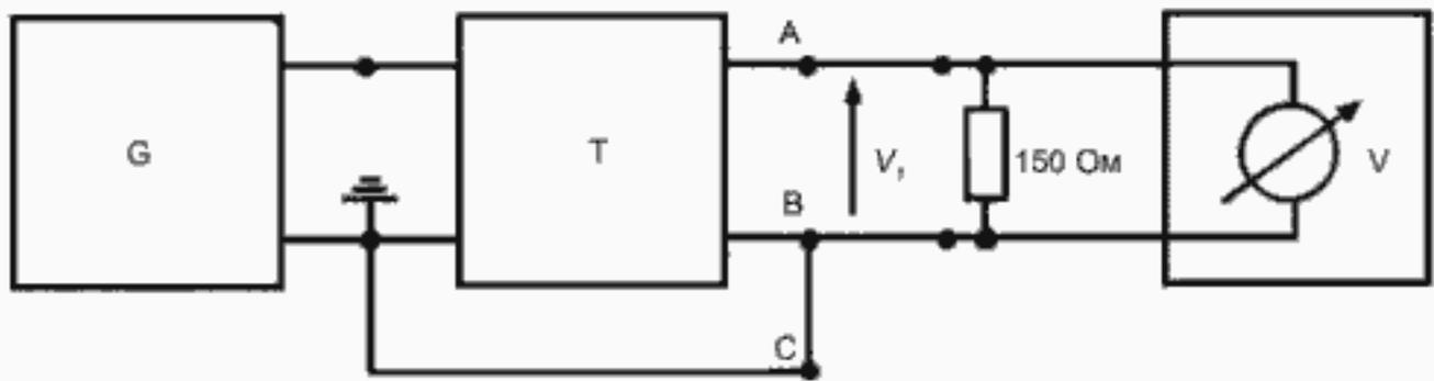
Рисунок А.1а – Измерение  $V_1$
