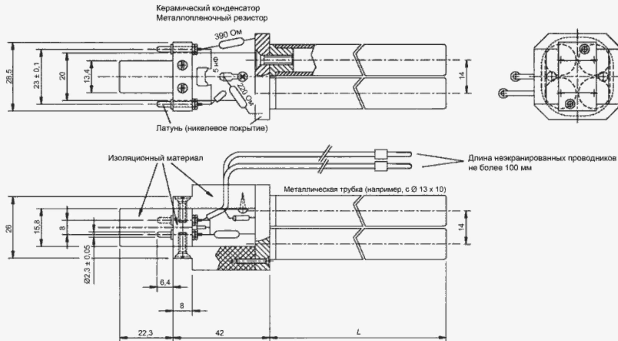
L равно длине реальной люминесцентной лампы минус 42 мм
