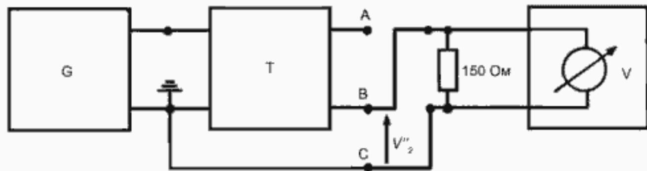
Рисунок А.1с – Измерение  $V''_2$
