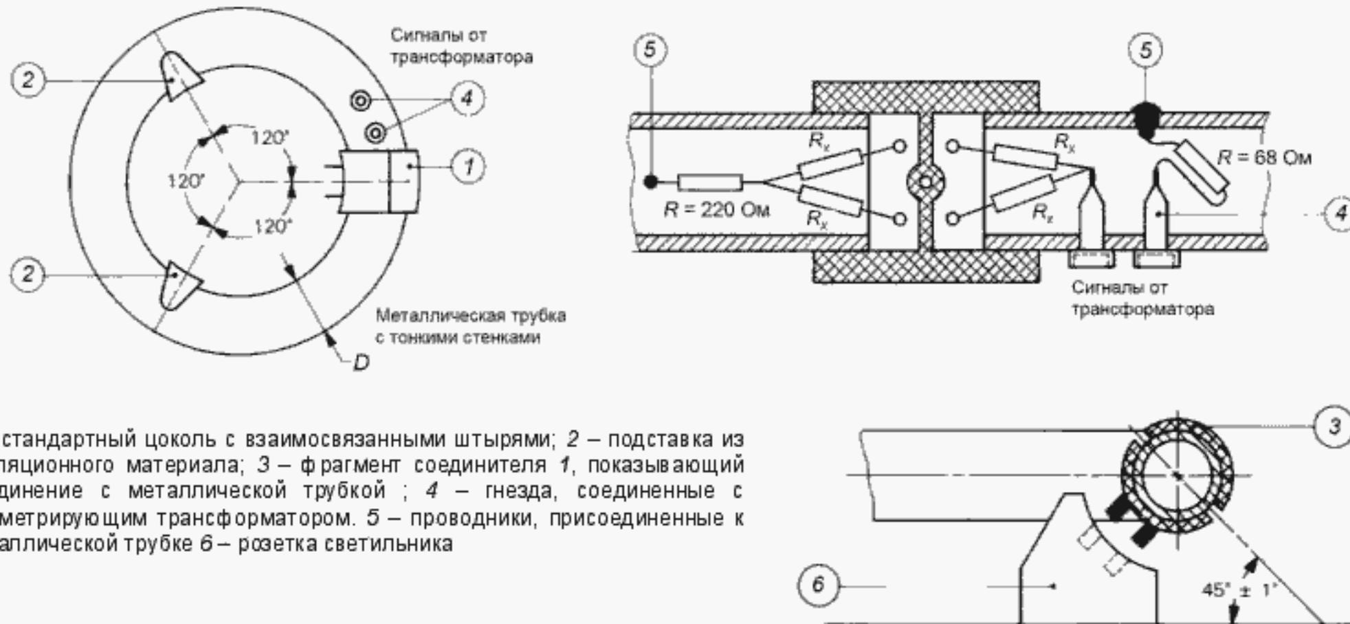
1 – стандартный цоколь с взаимосвязанными штырями; 2 – подставка из изоляционного материала; 3 – фрагмент соединителя 1, показывающий соединение с металлической трубкой; 4 – гнезда, соединенные с симметрирующим трансформатором. 5 – проводники, присоединенные к металлической трубке 6 – розетка светильника
