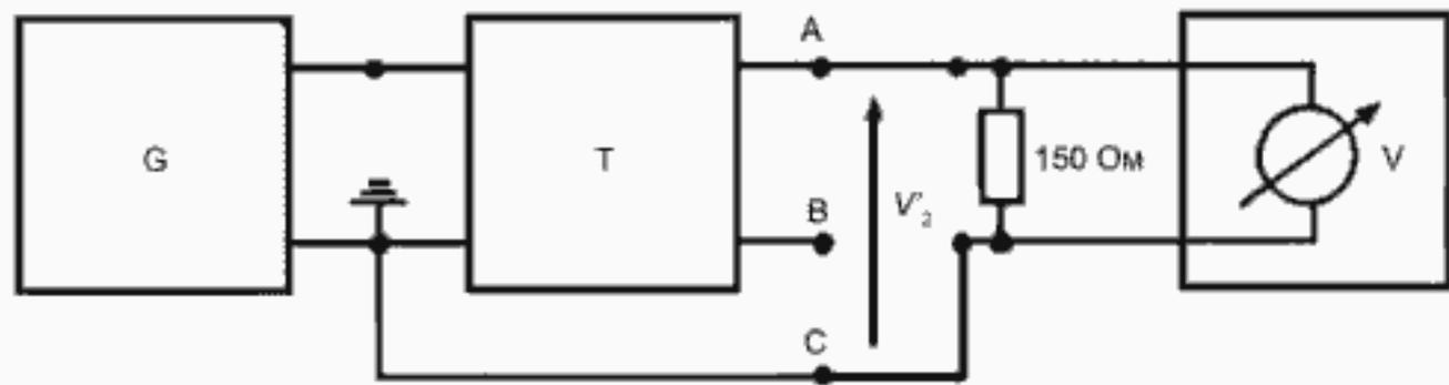
Рисунок А.1б – Измерение  $V'_2$
