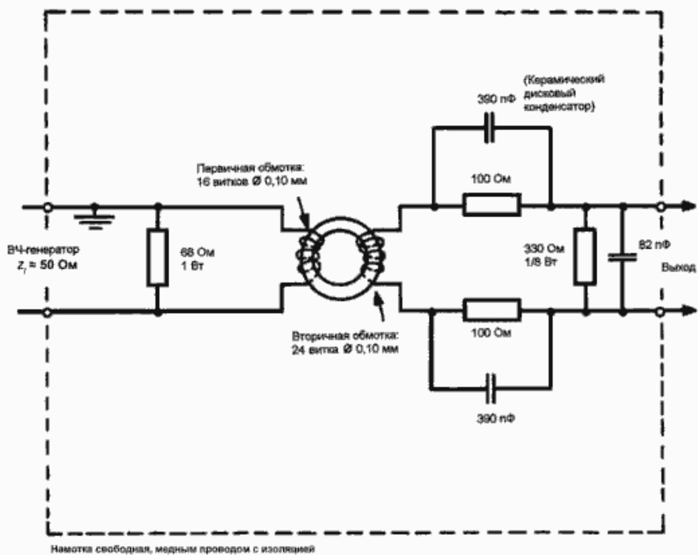
Рисунок А.2а – Схема симметрирующего трансформатора
